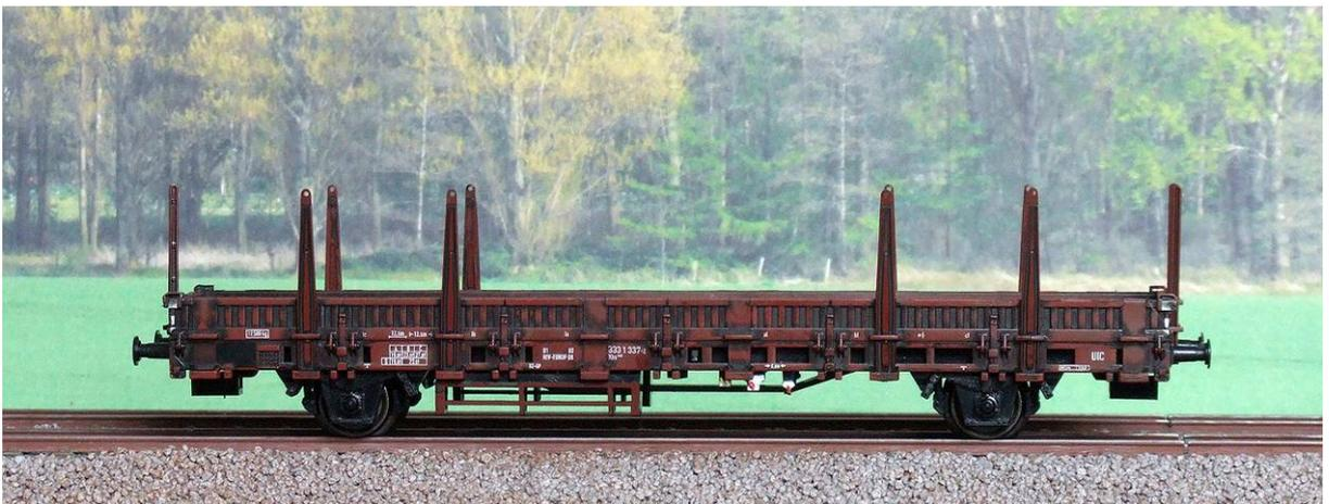
Erst jetzt kommt die Airbrush zum Einsatz. Hierbei führen neben der Airbrush-Technik an sich vor allem viele unterschiedliche sehr dünne Farbaufträge zu einem guten Ergebnis. Dabei ist auch zu berücksichtigen, wie der entsprechende Farbton beim Vorbild entsteht (z.B. Ruß und Staub von oben, Flugrost und Bremsstaub von unten). Beim Kbs wurden folgende Farbtöne (s.a. Farbtabelle im Anhang) aufgebracht:
